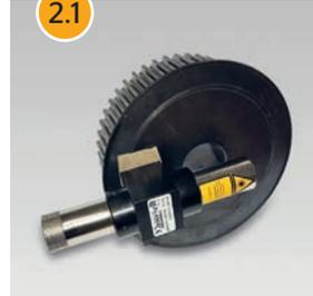
**2.1** Bei nicht-magnetischen Scheiben können Sie das Tool mit (doppelseitigem) Klebeband befestigen.
