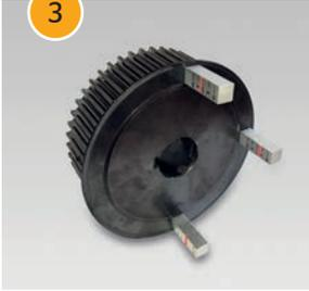
3. Ablesen der Position des Laserstrahls an den Zielmagneten.
