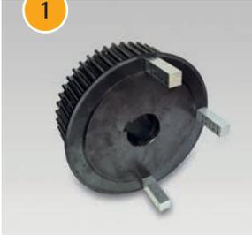
**1.** Anbringen von drei Zielmagneten an der Stirnseite einer Riemenscheibe. Positionen: ca. 0°, 90° und 270°.
